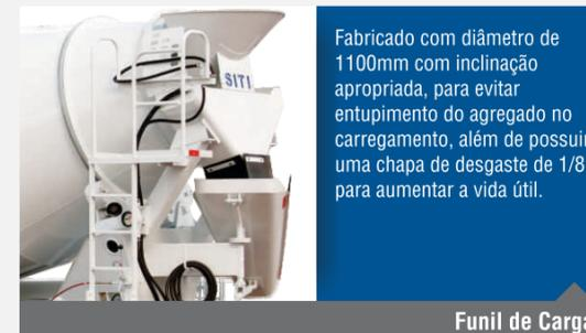
Fabricado com diâmetro de 1100mm com inclinação apropriada, para evitar entupimento do agregado no carregamento, além de possuir uma chapa de desgaste de 1/8" para aumentar a vida útil.
