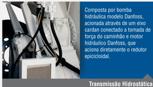
Composta por bomba hidráulica modelo Danfoss, acionada através de um eixo cardan conectado a tomada de força do caminhão e motor hidráulico Danfoss, que aciona diretamente o redutor epicicloidal.
