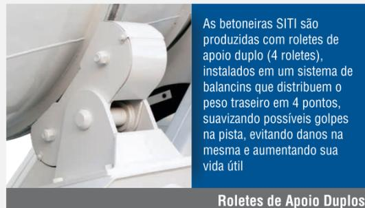
As betoneiras SITI são produzidas com roletes de apoio duplo (4 roletes), instalados em um sistema de balancins que distribuem o peso traseiro em 4 pontos, suavizando possíveis golpes na pista, evitando danos na mesma e aumentando sua vida útil.
