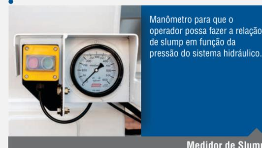
Manômetro para que o operador possa fazer a relação de slump em função da pressão do sistema hidráulico.
